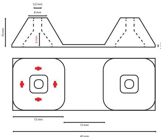
Les passes-câbles sont isolants, il n'est donc pas nécessaire d'ajouter de silicone ou autres composants. Afin d'éviter la stagnation d'eau, et faciliter le séchage, en cas de projection d'eau, ou de condensation, sur les passes-câbles, il est préférable de laisser les passe-câbles libres au niveau de la trouée.
